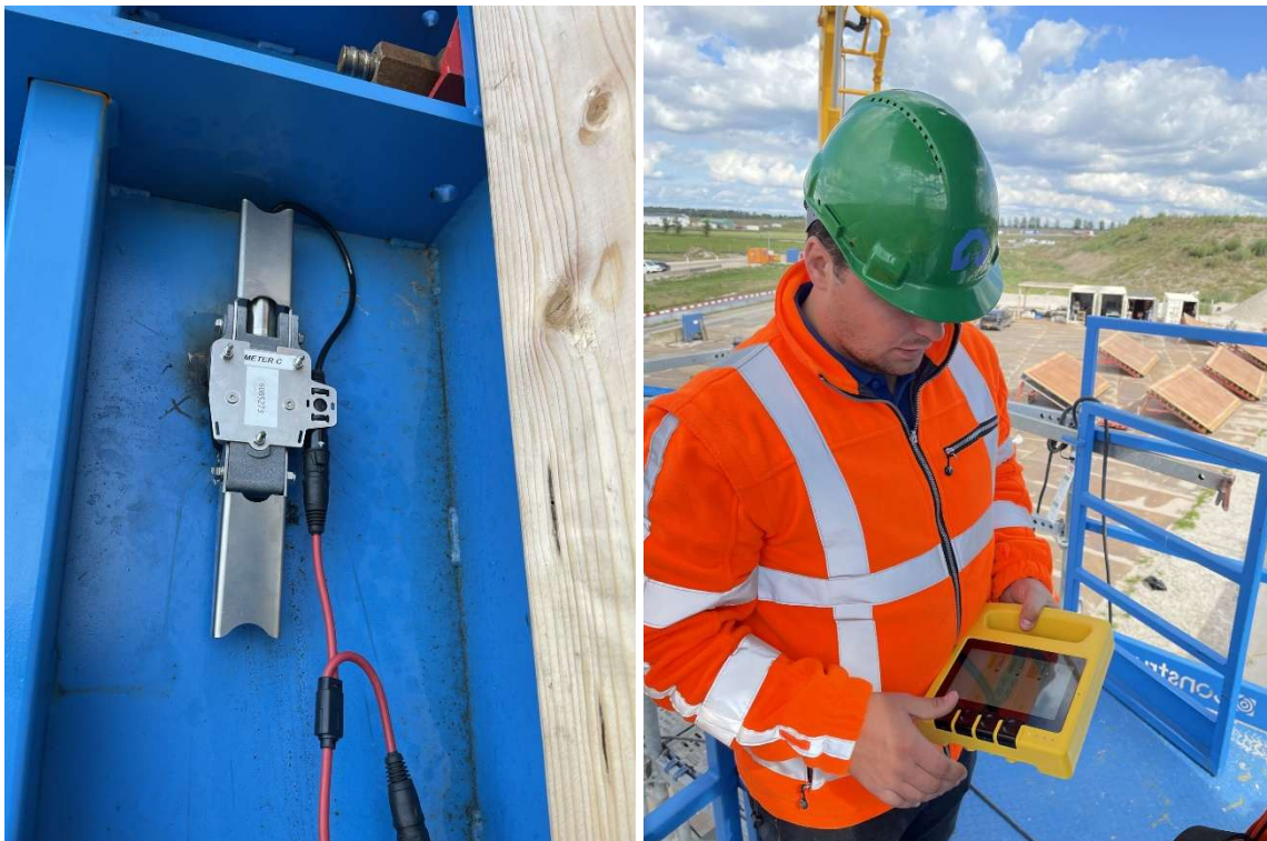
3 Druksensor en realtime uitlezing van de meetgegevens
