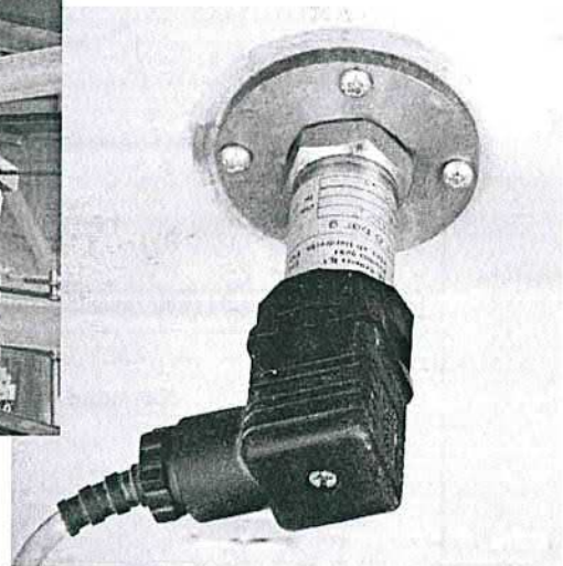
Figuur 15 - De sensor voor het meten van de betonspeciedruk
