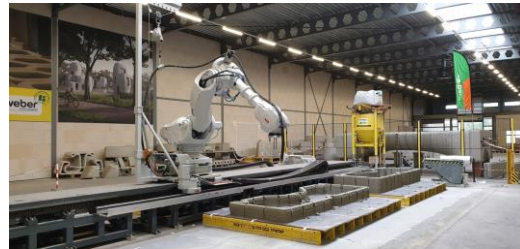
3D betonprintsysteem met silo met droge mortel, pomp, slang en printkop op robotarm
