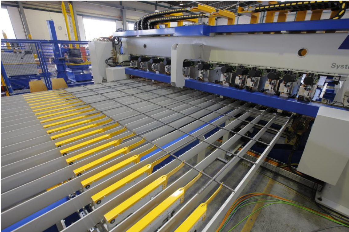
Figuur 8 - Staafnettenmachine in een gewone wapeningscentrale voor het leveren van staaf- en pasnetten, ook als er slechts een enkel net van een bepaald type nodig is en de producten van deze machine.
