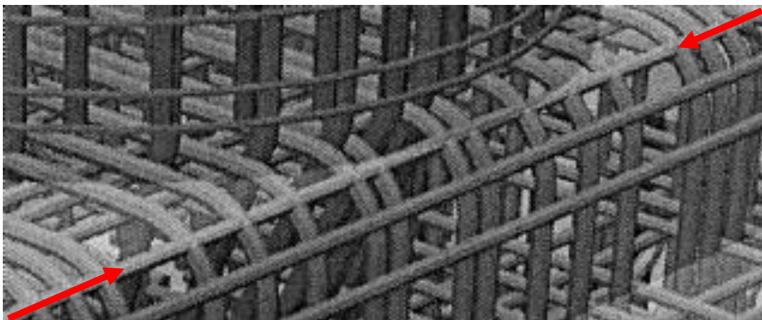
Figuur 12 - 3D-tekening met een fout. De diagonaalstaaf gaat door de beugels heen.
