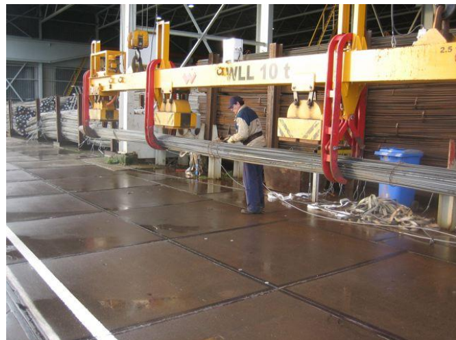
Figuur 37 - Het verwijderen van de bindsels
