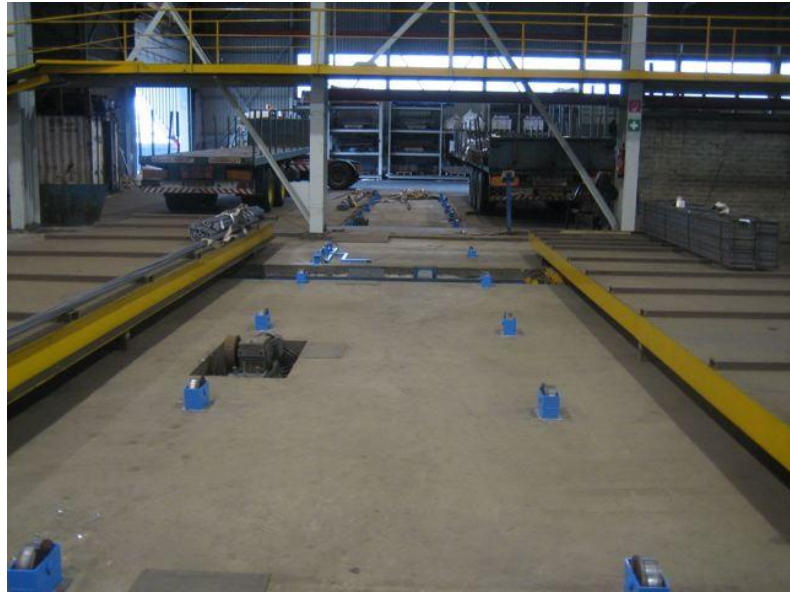
Figuur 39 - De platte wagens kunnen langs en dwars vervoerd worden doormiddel van aangedreven rollen.
