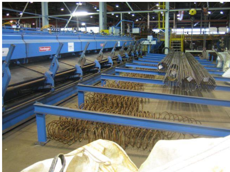
Figuur 7 - Een volautomatische lasmachine voor rolmatten, die gebruik maakt van rollen staal
