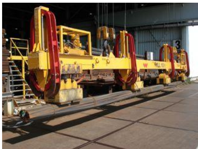
Figuur 35 - Het aanpakken van een bundel staal met 10 tons magneten. De armen zijn in ruststand.
