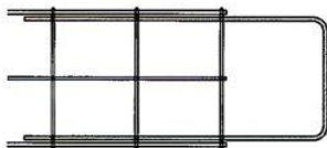
Figuur 42 - Dwarsbalk met losse haarspelden
