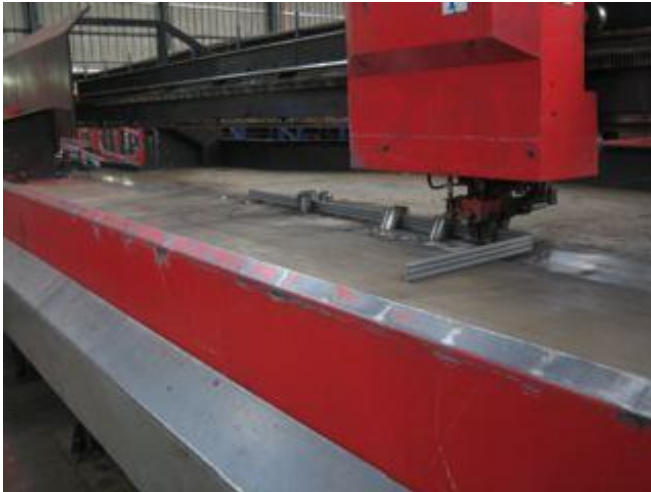
Figuur 4 - Een knip- en buigautomaat voor zwaarder betonstaal
