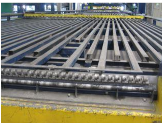
Figuur 30 - Een vingerbuigbank aan het eind van de aflegtafel
