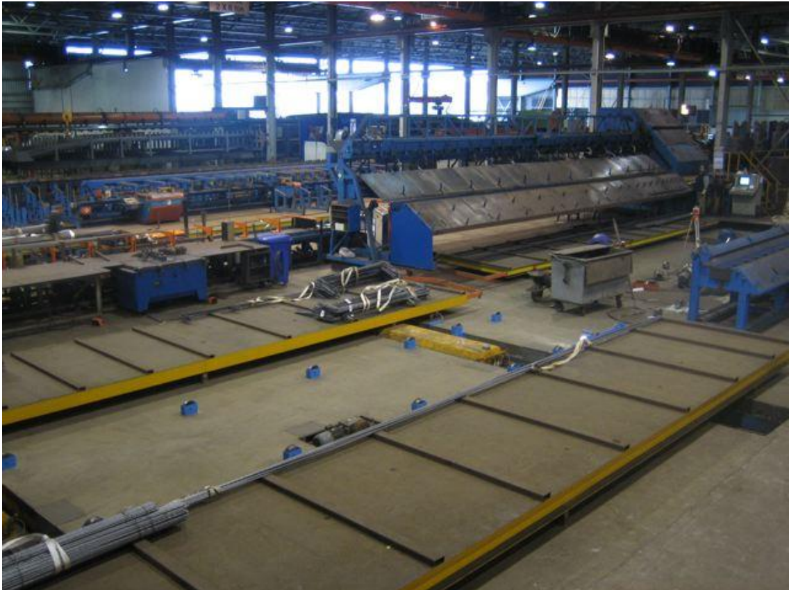
Figuur 1 - Eén van de moderne wapeningscentrales in ons land, die met elkaar goed uitgerust zijn voor het leveren van prefab wapening voor niet standaard constructies.
