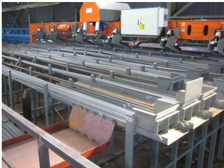
Figuur 5 - De achterzijde van een grote knipmachine
