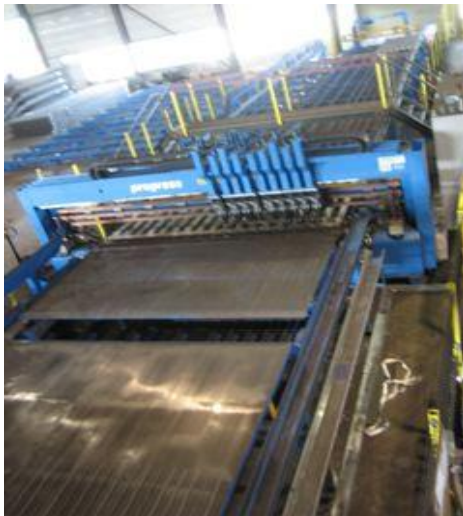
Figuur 28 - Het lassen en afleggen van de netten
