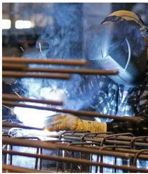
Figuur 24 - Het handmatig Mig-mag lassen
