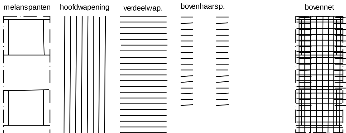
Figuur 38 - De opbouw van het bovennet met losse haarspelden
